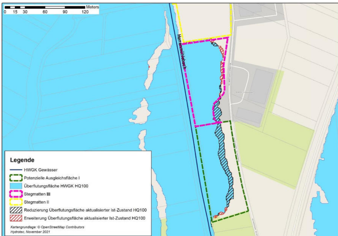
Abbildung 4-4: Überflutungsflächen HQ100 in Stegmatten III und in der „potenziellen Ausgleichsfläche I“: HWGK und aktualisierter Istzustand
