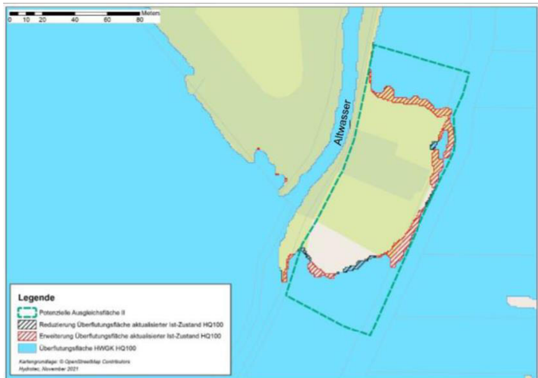
Abbildung 4-5: Überflutungsflächen HQ100 in der „potenziellen Ausgleichsfläche II“: HWGK und aktualisierter Istzustand
